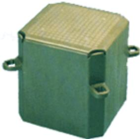
Die einzelnen Elemente sind mit einem Gewicht von ca. 6,2 kg sehr leicht zu handhaben und gewährleisten eine enorme Tragfähigkeit von bis zu 370 kg/m<sup>2</sup>. Bei Abmessungen von 50 x 50 x 50 cm, beträgt das Freibord standardmäßig rund 40 cm. Sie bestehen aus einem hochwertigen UV-Stabilisierten, verrottungsfesten Kunststoff mit praktisch unbegrenzter Lebensdauer. Serienmäßig sind die Pontons und Bolzen in grün oder blau lieferbar. Andere Farben sind ebenfalls realisierbar.
