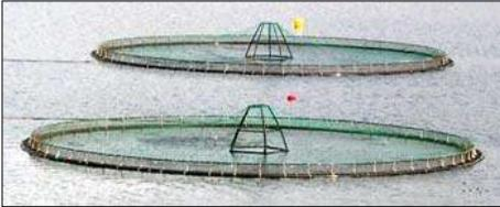
Wir liefern eine breite Palette an Einzel-, Doppel- und Tripple-Gehegeringen, die aus Polyethylen Rohren (HD-PE 80-100) von 200 bis 450 mm Ø gefertigt sind. Klemmen und Geländesteher aus verzinktem Stahl oder gespritztem Kunststoff werden meist alle 2-3 montiert.
