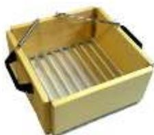
Die Abstände des Gitterrostes können vom Handgriff aus mit dem Daumen verstellt werden, indem man den Hebel bei jeder Raste nach oben oder unten drückt und des Gerät diagonal zu einer Raute verschiebt. Der Rahmen des schwimmenden Gerätes ist aus seewasserbeständig, imprägniertem Holz gefertigt und hält zwischen den ALU-Sortierstäben einen exakten Abstand ein.
