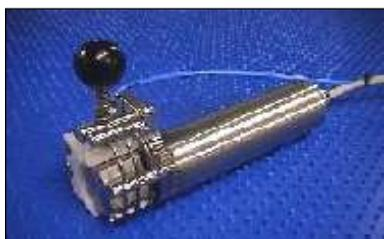
Für die Entfernung der lästigen Steh- bzw. Zwischenmuskelgräten bei größeren frischen, aufgetauten oder geräucherten Filets (ab etwa 150 g Filetgewicht wie: Lachs, Forelle oder Saibling) stehen verschiedene Maschinen vom Kompakt-Handgerät bis zum Band-Vollautomat (mit 1-4 Ausziehköpfen) zur Verfügung. Alle Maschinen sind nach den gleichen Grundsätzen aus rostfreiem Material hergestellt.
