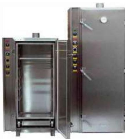
Ein Rauchrohranschluss (120 mm Ø), die doppelwandige Isolierung (50 mm) und die abgedichtete Türe mit stabilen Verschlüssen ermöglichen auch den Betrieb in Räumen.
