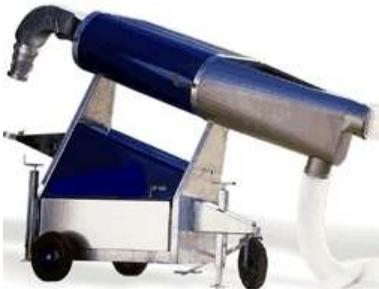
Für das Befördern von lebenden Fischen zu Sortiermaschinen und/oder Beladen von Transportbehältern etc. hat sich diese Fischvakuumpumpe bestens geeignet. Die Fische (bis 5 kg Stückgewicht und bis zu 16 t/h) werden von einem Ansaugtrichter über einen Ansaugschlauch (6 m lang) von zwei 150 Liter Vakuumbehältern wechselseitig bis zu 5 m hoch angesaugt. Durch einen 0,6 m<sup>2</sup> großen Separator mit 8 mm Gitterabstand werden sie vom Wasser getrennt und rutschen dann weiter.
