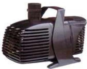
Diese Pumpen mit Vortex-Freistrom Laufrad aus Kunststoff können sowohl im Wasser (nass) als auch außerhalb des Wassers (trocken) betrieben werden und sind für Feststoffe bis 6 mm (Förderleistung max. 20-40 m<sup>3</sup>/h, Förderhöhe max. 6,5-8,5 m) geeignet. Durch die verschleißfeste Keramiklagerung sind sie für Dauerbetrieb geeignet. Alle Spannungsführenden Teile sind völlig in Kunstharz eingegossen und ein Thermoschalter dient als Überlastsicherung.
