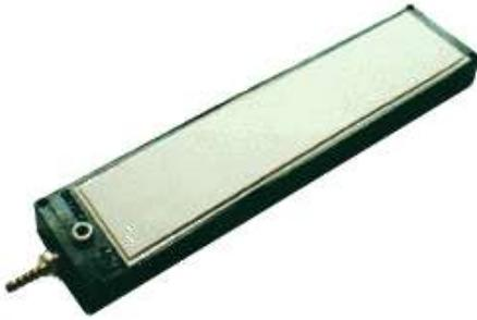
Die winzigen, nur 0,3 µm (Mikron) kleinen Poren produzieren im Wasser einen Schleier von kleinsten (10-200 µm) Gasbläschen und ermöglichen ohne Energieaufwand eine Sauerstoffsättigung von über 120 % zu erreichen. Der Arbeitsdruck liegt zwischen 25 und 35 psi, und sollte 50 psi (3,5 bar) nicht übersteigen. Der Ausströmer ist mit 4 Befestigungslöcher, sowie einem Gewinde und Anschlussadapter für den (6 mm) Sauerstoffschlauch ausgestattet.
