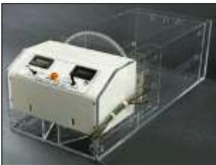
Diese patentierte Sortiermaschine verwendet die derzeit modernste Technik (Fiber-Optik und Infrarot-Licht) um rund 100.000 Salmonideneier je Stunde mit höchster Genauigkeit (ca. 98-99 %) auszulesen, und ist mit oder ohne Zählsysteme (für befruchtete und unbefruchtete Eier) verfügbar. Nach dem Einlegen der entsprechenden Sortierscheibe können praktisch Salmonideneier fast jeder Größe (ab 3 mm) sortiert werden.
