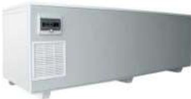
Die Anlagen werden komplett mit im Boden eingebauten mechanisch-biologischen Filter (*Lithothamnium calcareum*) mit Vorfilter, Titan-Kühlgerät (R134) mit Digitalanzeige und Thermostat, UV-C Anlage, Umwälzpumpe mit PVC-Verrohrung, geliefert. Sie sind für einen Stromanschluss von 380 V und eine Arbeitstemperatur von 5-25 °C ausgelegt.
