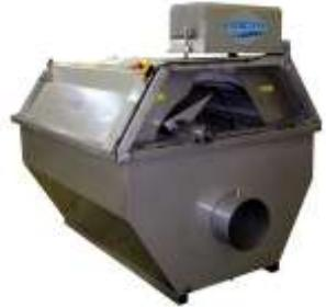
Wir bieten eine komplette Produktreihe von Trommelfilter aus Edelstahl an, die eine mechanische Reinigung von Abwasser für geringe bis starke Verschmutzungsgrade, bei Filter-Maschenweiten von 20-100 µm, ermöglichen. Sie sind komplett mit oder ohne Hochdruck Spülpumpe, Steuerungskasten und Installationsbehälter lieferbar.
