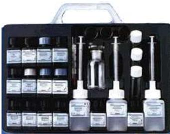
Dieses Kompakt-Labor Kofferset ist ausgestattet mit Flüssigreagenziensätzen zur Farbkartenanalyse von: Sauerstoff, pH-Wert, Säurebindungsvermögen, Härte, Ammonium, Nitrit, Nitrat, Phosphat und Temperatur.
