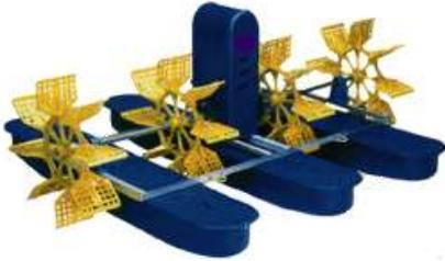
Diese Schaufelradbelüfter werden weltweit eingesetzt. Sie sind mit 2-6 Schaufelrädern, in verschiedenen Motorstärken von 0,75 bis 2,20 kW (für 220 oder 380 Volt) erhältlich und haben ein Gewicht von 80-120 kg. Der Sauerstofftrag liegt gewöhnlich etwa bei 1,6 kg/kWh. Welle und Rahmen sind aus Stahl gefertigt, die Schaufelräder aus speziellem Plastik, und die H-förmigen Schwimmer aus dickem Kunststoff.
