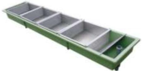
Durch eine neue Technik sind die Lochbleche (1-2 mm Lochung), ohne Klebewulst in den Kunststoff eingearbeitet und erlauben so eine gleichmäßige Durchflutung. Jeder Einsatz hat eine Erbrütungskapazität für etwa 10.000 bis 20.000 Forelleneier (1-2 Liter). Um die Rinne nach der Erbrütung auch zur Anfütterung zu verwenden, ist als Zubehör ein schräges Absperrsieb erhältlich.
