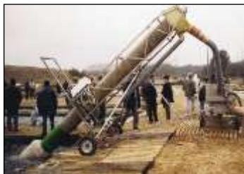
Dieses Fördergerät arbeitet mit einer "Archimedischen Schraube" von 38 cm Durchmesser (größere auf Anfrage) und ermöglicht bis zu 6 t/h Fische jeder Art und einer Größe von 3 bis 3000 g zu bewegen. Das Gerät ist mobil einsetzbar und wird hauptsächlich für den Transport von lebenden Fischen zwischen Teichen oder Netzgehegen, sowie zu Sortiermaschinen und Transportbehältern usw. verwendet.
