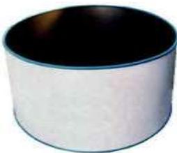
Die frei aufstellbaren oder eingrabbaren Becken (2-8 m Ø) bestehen aus einer 0,4-0,7 mm starken, verzinkten Stahlwand die innen schutzlackiert und außen kunststoffbeschichtet ist. Die Handlauf- und Bodenschienen bestehen aus Kunststoff. Die Innenauskleidung besteht aus 0,6-0,8 mm starker PVC-Folie mit hoher Passgenauigkeit in schwarzer oder blauer Farbe. Als Zubehör ist ein Bodenschutzfließ (5 mm) lieferbar.
